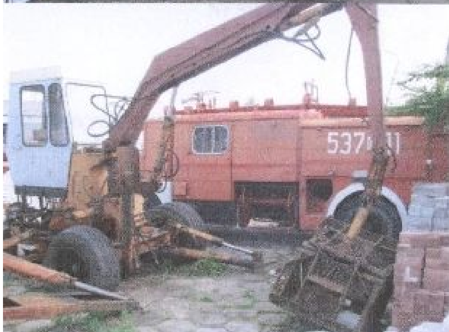
Ładowarka doczepiana i zasilana od ciągnika rolniczego Agrozet Hompulec
